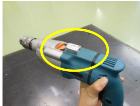
設備の振動レベル確認
